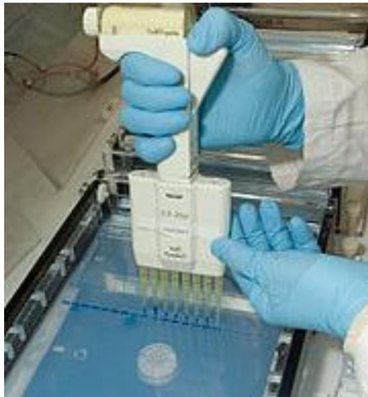
*Caricamento del gel con una multipipetta.*
